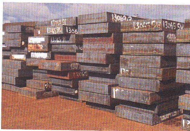
Les brames sont moulées à partir d'acier à l'état liquide. Le volume d'acier solide obtenu est égal à 94 % du volume d'acier liquide utilisé.
