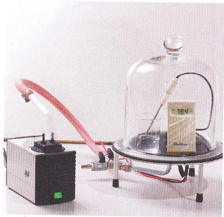
Fig. 2 Ébullition de l'eau sous pression réduite
