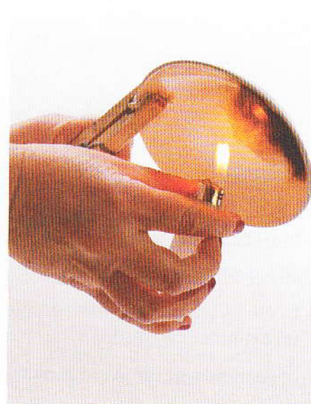
Fig. 3 Combustion incomplète du butane
