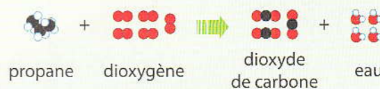
Fig. 3 Combustion du propane
