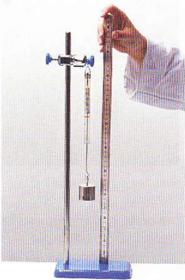
Fig. 1 Mesure de la longueur du ressort
