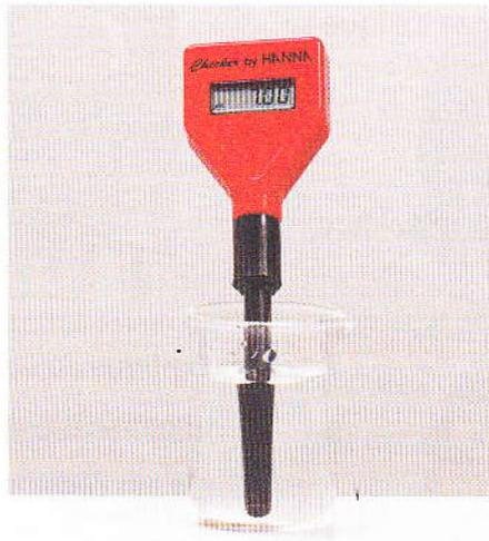
Fig. 2 Mesure du pH d'une eau minérale
