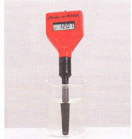
Fig. 3 Mesure du pH de l'eau de Javel
